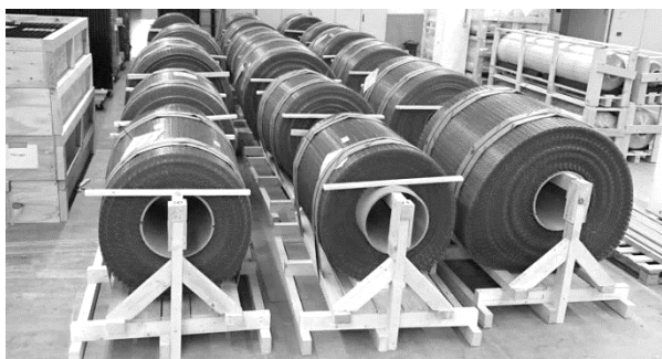
Abbildung 10: Einweg-Holzgestelle zum Transport von gerollten Bewehrungsgittern
