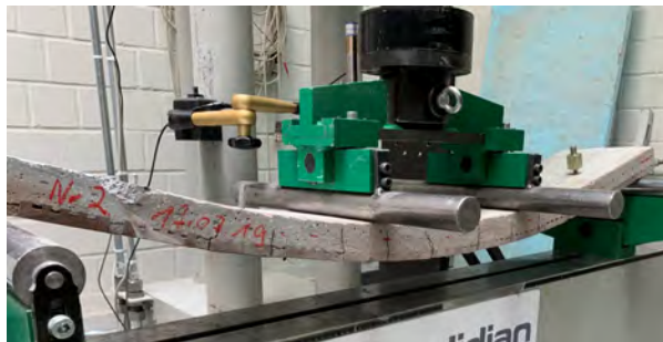
Abbildung 29: Zwei-Punkt-Biegeversuch an einem Plattenstreifen mit nichtmetallischer Bewehrung
