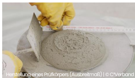
Herstellung eines Prüfkörpers (Ausbreitmaß) | © C³Verband
