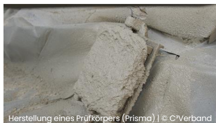
Herstellung eines Prüfkörpers (Prisma) | © C³Verband
