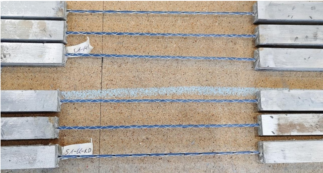
Abbildung 1: präparierte Faserstrang-Prüfkörper, welche einem Gitter entnommen wurden
