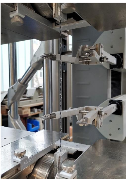
Abbildung 2: exemplarischer Versuchsaufbau der Standardprüfung des Faserstrangzugversuchs, entnommen aus [1]
