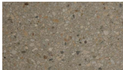
Frisch gesandstrahlte Betonoberfläche mit einer Rauigkeitszahl 1 und der dazugehörenden Rautiefe von 1 mm. © C³Verband
