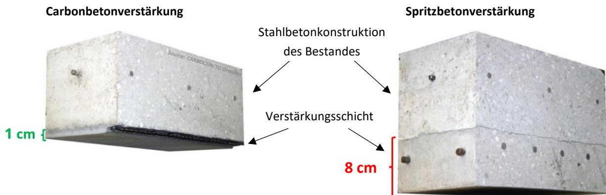
Abbildung 1: Vergleich der Schichtstärken einer Verstärkung mit Carbonbeton und Spritzbeton (© CARBOCON GMBH/TU Dresden)
